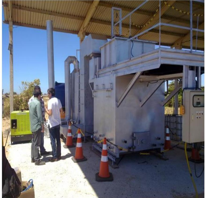
Implantação de unidade em Erechim – RS com capacidade de tratamento de 10 t/d de resíduos (similar a ser implantada em Roncador – PR)
